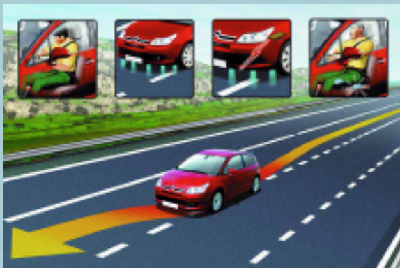
Funcionamiento del Sistema LDW del Citroën C4.
